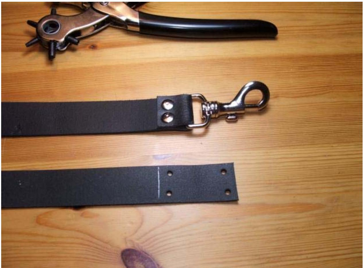
Nun schiebt man das eine Ende von dem Riemen in den Bügel des Schnappkarabinerhakens und klappt das Ende um. Somit sollte dann der Karabiner in einer Schlaufe sitzen und die Löcher recht genau übereinander liegen. Nun steckt man die Niete (Ober- und Unterteil) in die Löcher und fixiert das ganze durch Zusammendrücken mit der Hand. Genauso geht man auch mit dem anderen Ende von dem Riemen vor.
